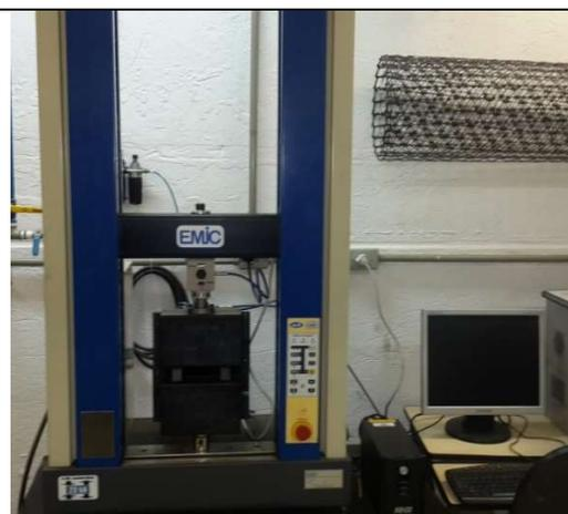
Figura 02. Ensaio de tração de faixa larga.
