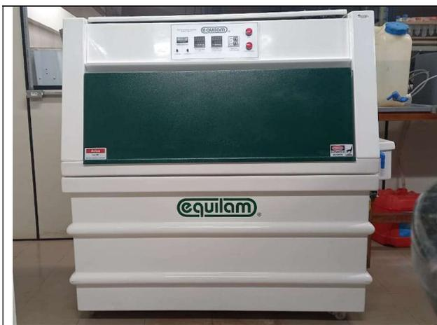
Figura 01. Câmara de Envelhecimento Acelerado.
